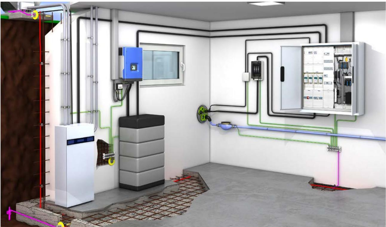
> Bild 8: Niederimpedante Anbindung von Betriebsmitteln in den Potentialausgleich durch Nutzung der kombinierten Potentialausgleichsanlage als Potentialausgleichsleiter
