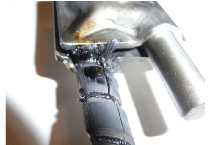
Prüflinge nach Belastung mit 20 kA (10/350 µs Blitzstrombelastung)
